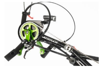
Vork, hoek en diepte instelbare crank (Attitude Manual & Hybrid)
